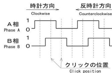
シャフトを時計方向に回すと、B相が低出力電圧(0)のときにA相が立ち上がります。反時計方向に回すと、B相が高出力電圧(1)のときにA相が立ち上がります。1クリックの移動でA相またはB相の一方が0→1または1→0に切り替わります。
